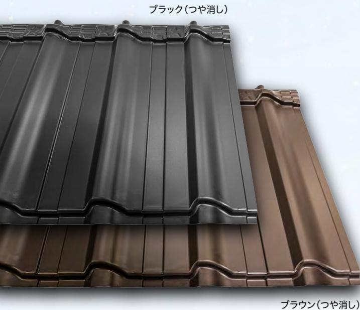
スタープルーフは、厚さ0.55mmのガルバリウム鋼板にフッ素含有量50%以上のフッ素樹脂を焼付塗装、いつまでも変わらぬ美しさを保ちます。金属屋根の中で星(Star)のように輝く美しさと強靭さを実証(Proof)する屋根(Roof)を意味しています。
